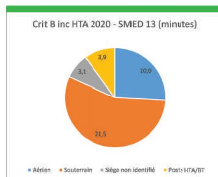
En outre le nombre d'incidents souterrains HTA a augmenté de 216 à 241 dont 55 sur des câbles CPI, soit 23% alors que les câbles CPI ne représentent que 2,4% des réseaux souterrains (env 139 km). Ce résultat nous conforte dans notre stratégie d'accélérer la dépose des câbles papier imprégné (CPI) sur le périmètre du SMED 13.
