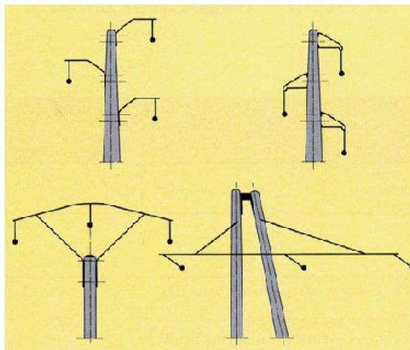
Figure 4 : Réseau électrique HTA nu - Technique suspendue
